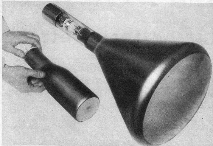
Der Vergleich der Metallfernrohr mit der Fernrohr aus Glas zeigt deutlich die wesentlich kleineren Abmessungen. Vergl. auch das Bild rechts unten.
